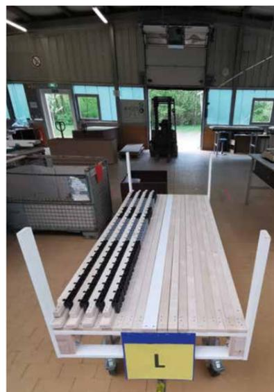
Selbstgebaute Arbeitshilfen erleichtern den Arbeitsalltag: Auf dem Bild ist eine „Longpalette“ zu sehen. Hier lassen sich die zusammengesetzten Außen- und Innenholme optimal lagern und transportieren.
